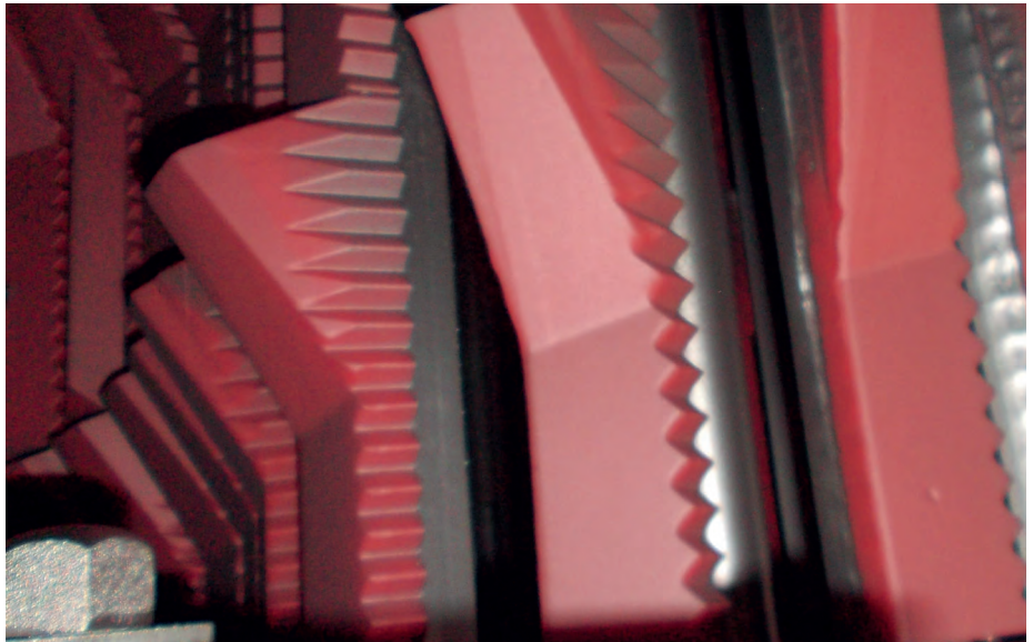
Abbildung 1: PUCEST Mitnehmer nach dem Einbau
